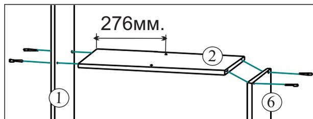
Схема крепления к стене.
